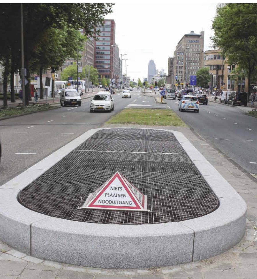
... und unterirdisch das Überbleibsel eines ehemaligen Atomschutzbunkers sowie Fluchtweg im Falle eines U-Bahnbrandes
